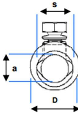
**Figura 1** - Conector emenda torquimétrico
